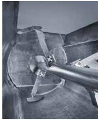
Pflugschar®-Mischer Typ DBE mit geöffneter Klappe: Öffnungswinkel 90°
