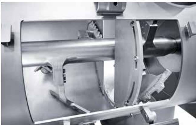
Öffnung in der Trommel mit davor angeordnetem Überlaufwehr
