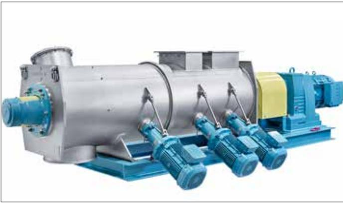
Pflugschar®-Mischer für kontinuierlichen Betrieb Typ KM 1200 Blick auf die Messerkopfmotoren
